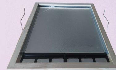
Le cadre est réalisé en bois avec l'isolant Balbitherm®.
